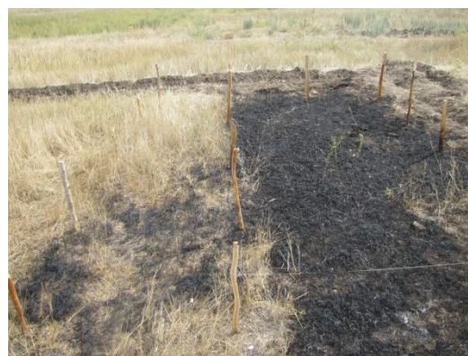
Рисунок - 4.12 Эксперимент с фланговым распространением пламени - вид на секторы с правого фланга
