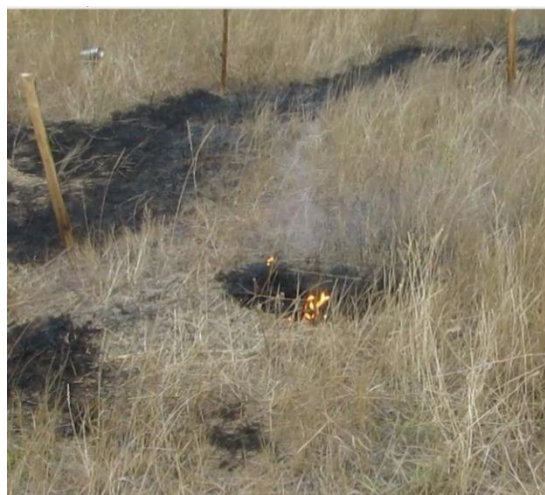
Рисунок 4.17 - Результаты поджога травяного покрова на огнестойком секторе – ГА, 28 г/л
