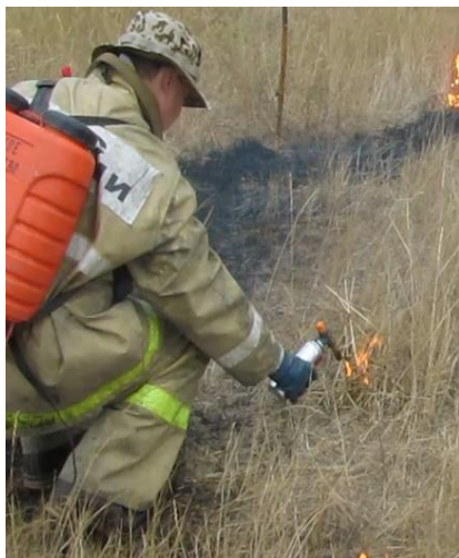
Рисунок 4.16 - Процесс поджога травяного покрова на огнестойком секторе – ГА, 28 г/л
