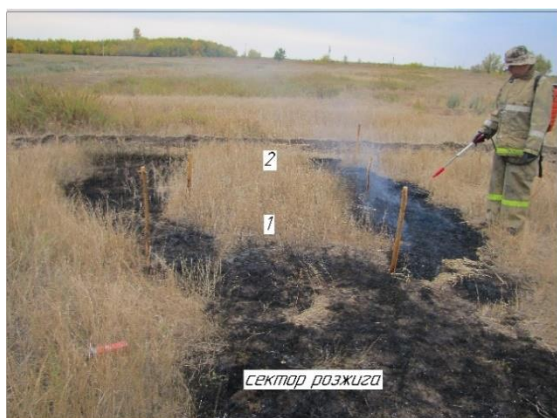
Рисунок - 4.13 Эксперимент с фланговым распространением пламени - вид со стороны сектора розжига
