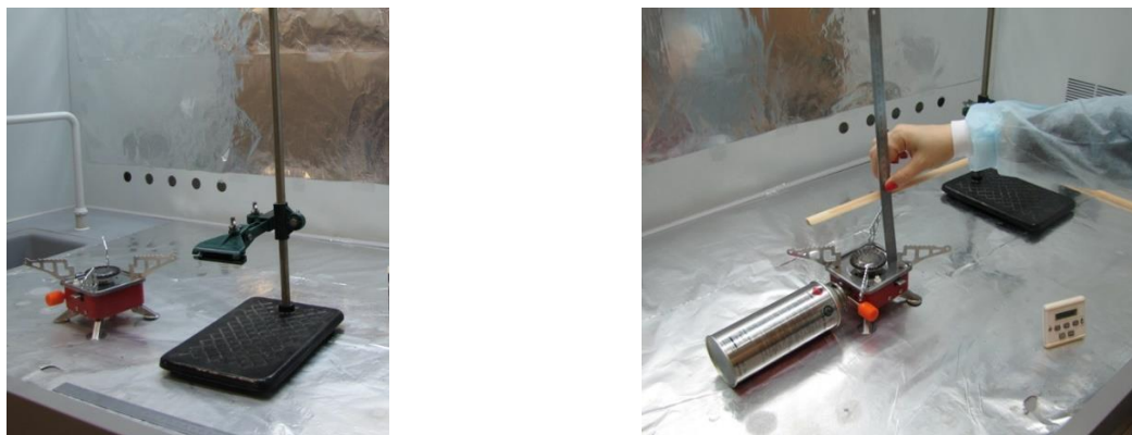
Рисунок 2.10 - Экспериментальная установка и определение оптимального расстояния исследуемого образца от зоны горения
