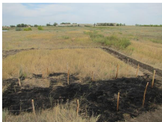
Рисунок 4.11 - Эксперимент с фланговым распространением пламени - вид со стороны сектора розжига
